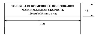
Высота заглавных букв должна составлять не менее 5 мм, а чисел «120» и «75» — не менее 20 мм, причем толщина каждой цифры должна быть не менее 3 мм. Высота строчных букв должна составлять не менее 5 мм. Весь текст должен быть помещен в рамку, причем его цвет должен контрастировать с цветом фона.
