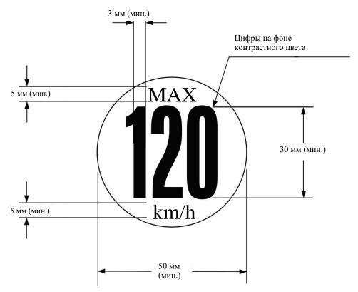
В случае транспортных средств, предназначенных для реализации в странах, где применяются единицы британской системы мер и весов, на наружной стороне колеса в заметном месте должен наноситься дополнительный постоянный предупреждающий знак, идентичный описанному выше знаку, однако вместо значения «120 км/ч» используют значение «75 миль в час».
