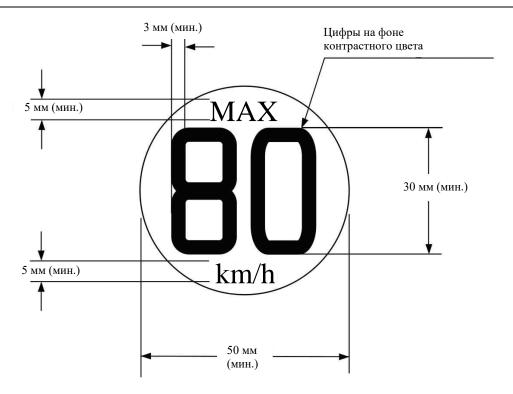
В случае транспортных средств, предназначенных для реализации в странах, где применяются единицы британской системы мер и весов, на наружной стороне колеса в заметном месте должен наноситься дополнительный постоянный предупреждающий знак, идентичный описанному выше знаку, однако вместо значения «80 км/ч» используют значение «50 миль в час».
