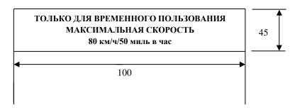
Высота заглавных букв должна составлять не менее 5 мм, а чисел «80» и «50» — не менее 20 мм, причем толщина каждой цифры должна быть не менее 3 мм. Высота строчных букв должна составлять не менее 5 мм. Весь текст должен быть помещен в рамку, причем его цвет должен контрастировать с цветом фона.
