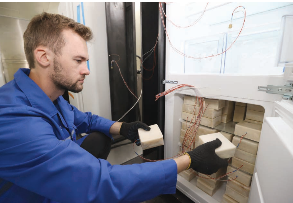
Инженер II категории БелГИСС Иван Ильковский проводит испытания холодильных приборов на энергоэффективность
